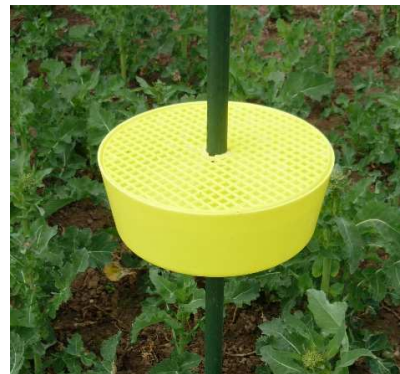
Bild 1: Höhenverstellbare Gelbschale mit Gitterauflage. Das Gitter schließt Beifang wie z.B. Honigbienen und auch Hummeln aus © Eickermann
